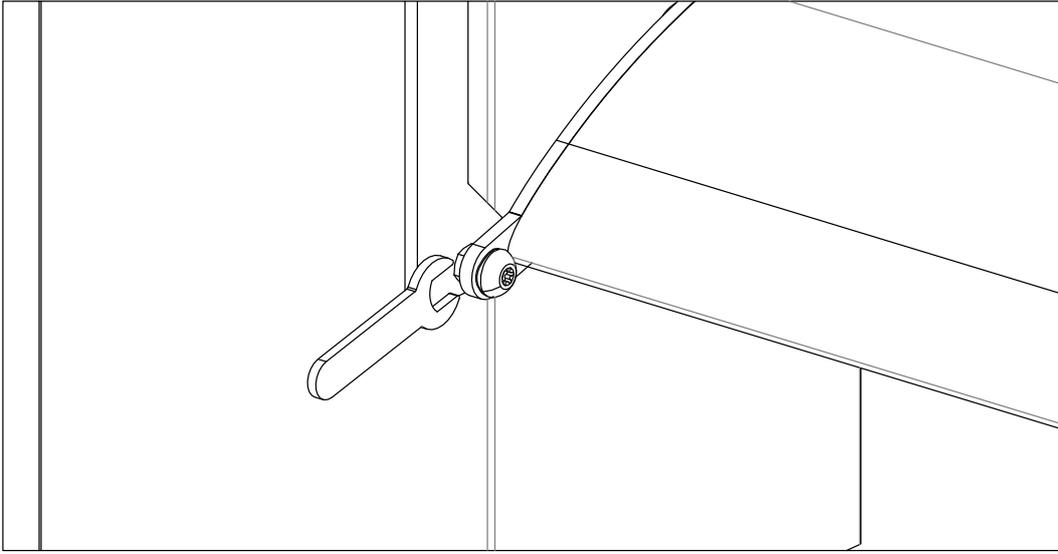
**Lamellen drehen sich zu leicht:** Sie können die Lamellen wie folgt stärker drehen lassen. Die Schraube mit Federscheibe und Mutter demontieren. Fügen Sie dann eine zusätzliche Federscheibe hinzu. Dieser Vorgang muss nicht für alle Lamellen durchgeführt werden. Passen Sie ein Raster nach dem anderen an, bis Sie das gewünschte Ergebnis erzielt haben.
